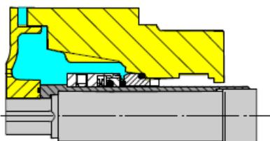
**Одинарное торцевое уплотнение в конической камере уплотнения**
