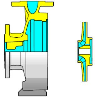
Спиральный корпус с закрытым рабочим колесом
