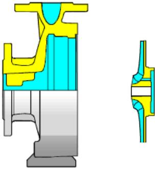
Спиральный корпус с полуоткрытым рабочим колесом
