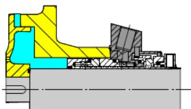
**Уплотнение типа «картридж» в цилиндрической камере уплотнения**
