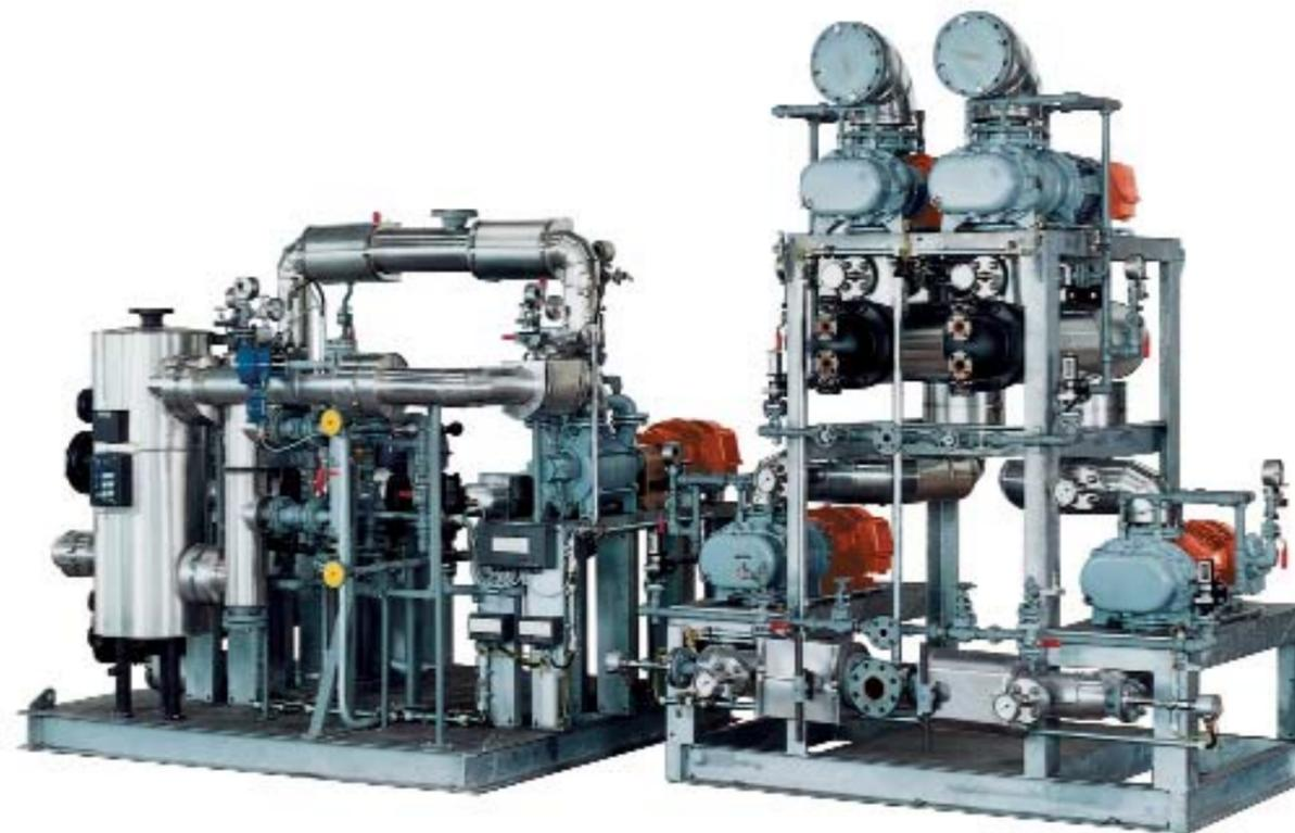
Многоступенчатая вакуумная система
