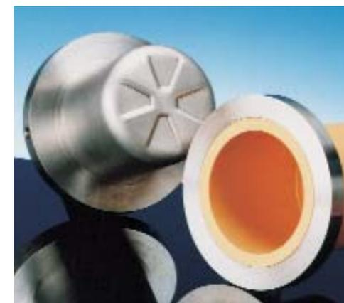
Применение керамических щелевых колпачков возможно также, если подаваемая жидкость при повышении температуры полимеризуется, кристаллизуется или затвердевает. Дроссельная втулка вблизи внутреннего магнита препятствует дополнительному проникновению тепла в процессе эксплуатации. Подшипник скольжения насоса гидродинамически разгружен и промазан изнутри. Для обеспечения прохождения смазочного материала он имеет специфическую форму. Внутренний подшипник выполнен из износостойкого
