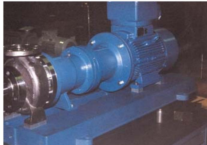
Электромагнитная муфта, расположенная со стороны насоса, оснащена двойным щелевым колпачком (внутри хастеллой, снаружи керамика). Электромагнитная муфта, расположенная со стороны мотора, работает на сухом ходу и снабжена щелевым колпачком из углеродистого пластика. Благодаря двойной конструкции электромагнитной муфты обеспечивается тройная защита от утечек.
