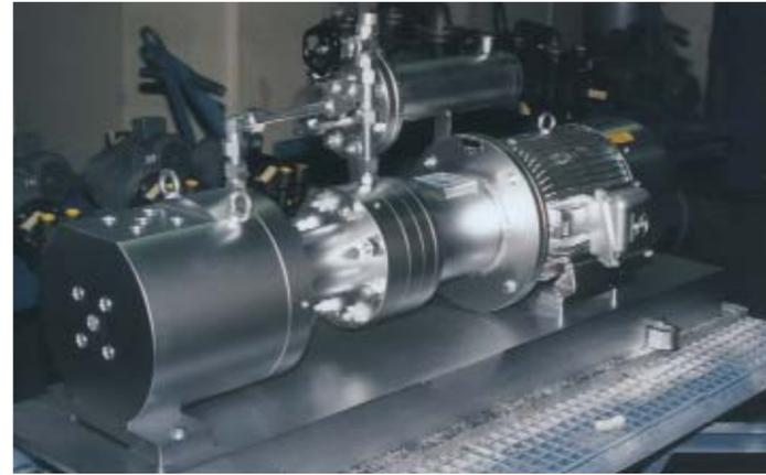
Электромагнитная муфта охлаждается при помощи теплообменника, а дополнительное лопастное колесо, вращающееся на валу насоса, поддерживает пониженную температуру и смазку подшипников.
