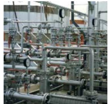
Насосы CEH в линии карусельного типа для розлива в бутылки
